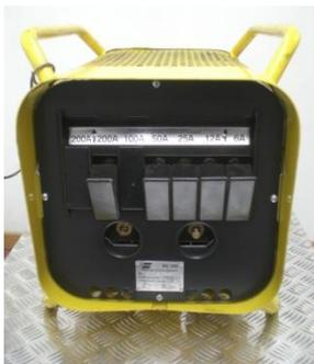
**Taratura con carico resistivo:** viene eseguita con una pinza amperometrica collegata a un **carico resistivo**. La taratura è affidabile in quanto i valori rilevati sono stabili e predefiniti grazie al carico resistivo che funge da resistenza elettrica fissa senza oscillazioni. Può essere usato ovunque non avendo bisogno di alimentazione.
